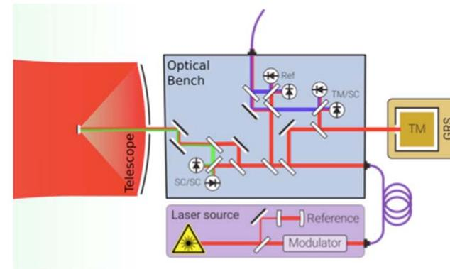
Figure 2 - Schéma d'un instrument de LISA (TM : Test Mass, GRS : Gravitational Reference Sensor)
